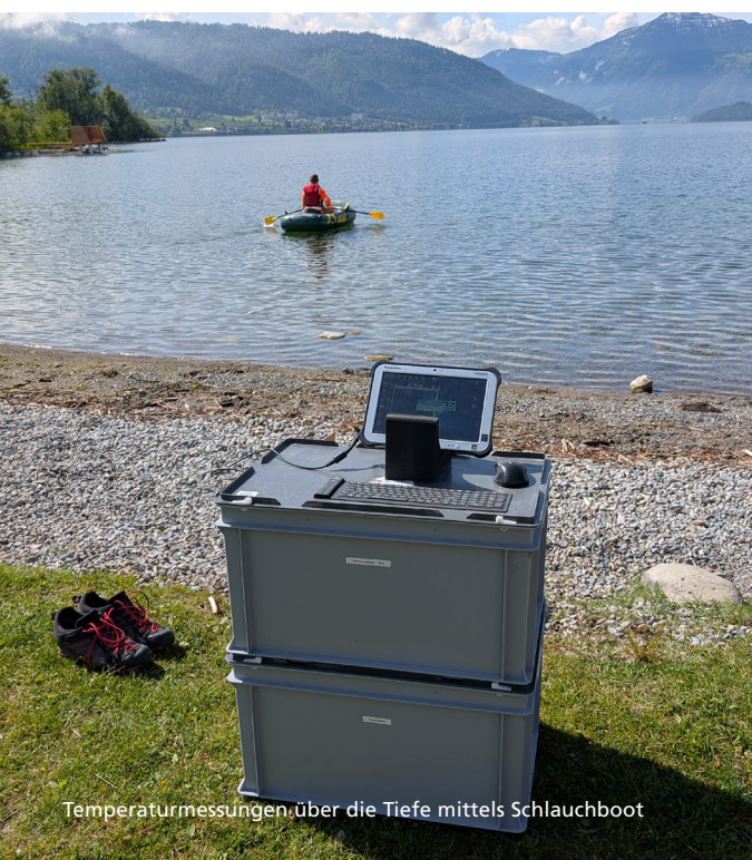
Bodenstation mit Live-Übertragung der Seegrunddaten
